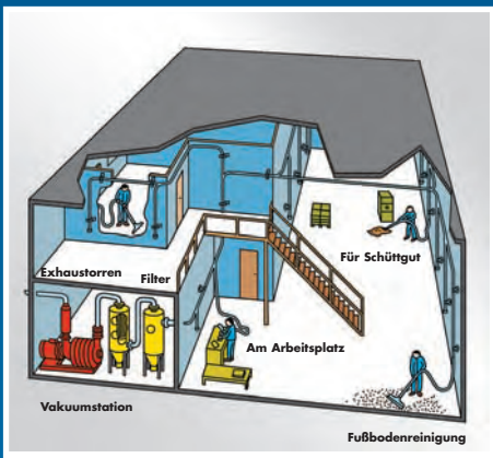
Zentrale Staubabsaugung für die Reinigung
