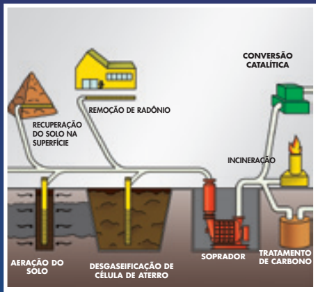
Tratamento de gás de aterro
