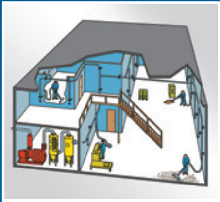
Центральная вакуумная чистка
